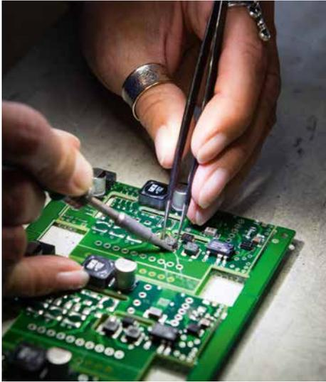
Mit unserem AOI-System von Orbotech und Stereomikroskopen werden sämtliche SMD-bestückten Leiterplatten optisch geprüft. Dies garantiert maximale Sicherheit, da Bestückfehler, Kurzschlüsse oder Bauteilverpolungen etc. erkannt, kategorisiert und bei Bedarf behoben werden. Auch die Erstellung einer Fehlerstatistik ist so möglich, Problemquellen können erkannt und Fehler vermieden werden.
